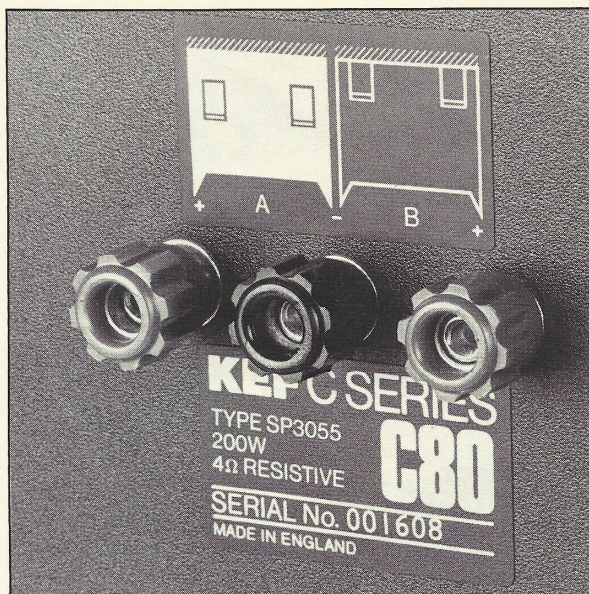
Kef on sovitettavissa erilaisiin sijoituksiin. Asennettaessa kaiutin lähelle seinää bassojen korostumista voidaan korjata käyttämällä B-liitintä, joka lisää keskialueen ja diskantin tasoa noin 2 dB.
