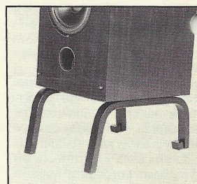
Kef on sovitettavissa erilaisiin sijoituksiin. Asennettaessa kaiutin lähelle seinää bassojen korostumista voidaan korjata käyttämällä B-liitintä, joka lisää keskialueen ja diskantin tasoa noin 2 dB.
